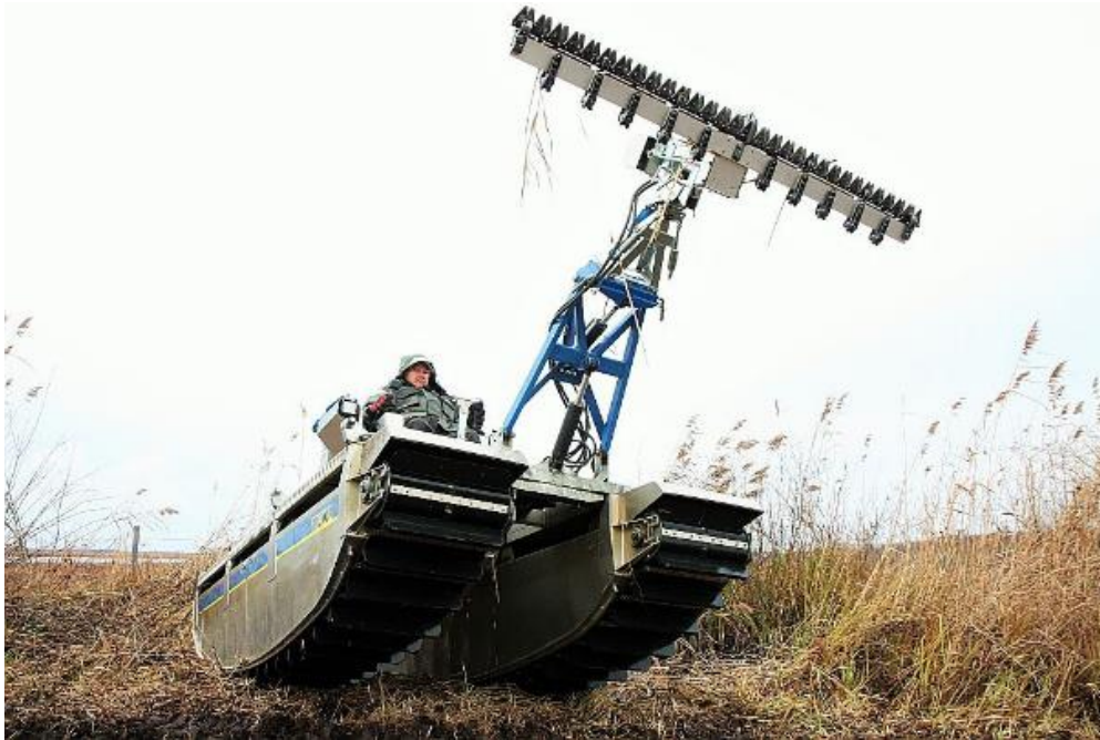
6.attēls. Niedru plāvējs "Truxor", kas var nopļaut 3 ha dienā un var plaut niedres arī zem ūdens (foto: G.Skagale) 8
